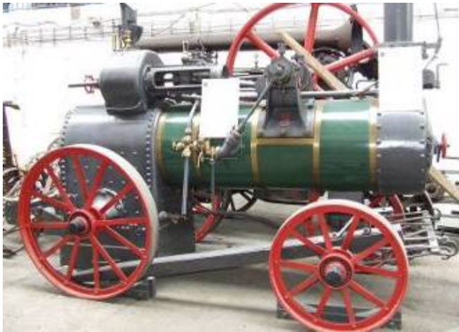
7. Збирка пољопривредних машина, Парна локомотива „Hofherr Schranz“, 330x140x280 cm, око 4000 kg (горе)
