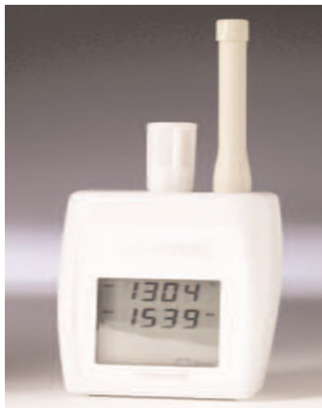
Data logger –merač toplote i vlažnosti u prostoru
